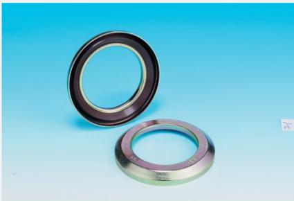
O Retentor Face Axial Nak tem função semelhante ao V-Ring, porém a carcaça de metal protege o lábio de vedação que pode ser prejudicado por sólidos, que comprometem a função de vedação. A carcaça de metal se fixa no eixo e protege as unidades de vedação internas e age como um desvio para sujeira, areia, fuligem, etc.
