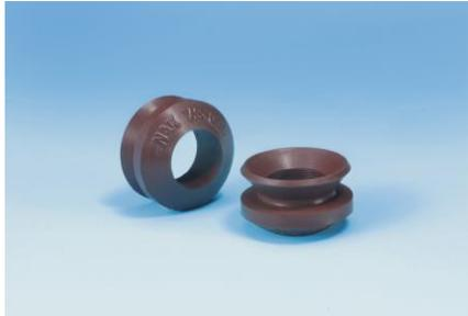
O V-Ring Nak é utilizado para proteger contra o ingresso de sujeira, pó e água na maioria das aplicações. Feito inteiramente de borracha, contém um corpo e um lábio cônico. O V-Ring é montado e gira com o eixo. O lábio veda contra a face perpendicular ao eixo. A interferência do corpo no eixo mantém o lábio na posição e o mesmo tempo veda contra o eixo.
